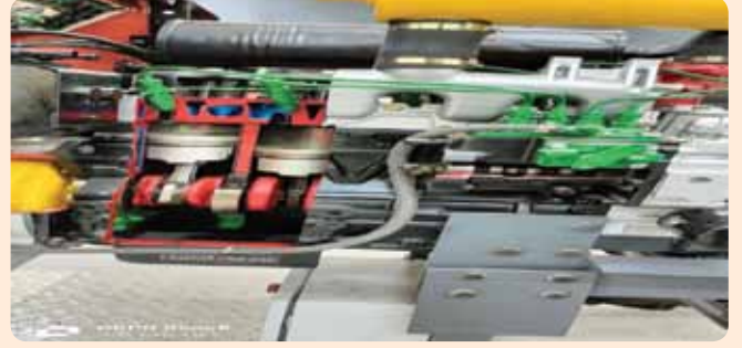
قطاع جانبي للمحرك يوضح شكل الاسطوانات من الداخل
