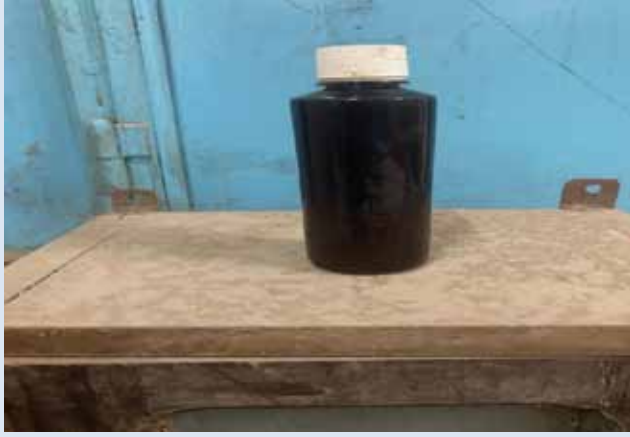
شكل رقم ١ وقود بيوديزل الهوهوبا تم تحضيره معمليا
